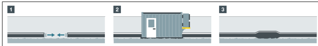
Abbildung 4: Schematische Darstellung der Kabelverbindungen (Muffen) 4
